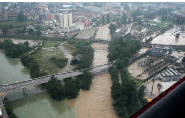
Bei Hochwasser: Die Kleine Emme steigt sehr rasch hoch und wird trüb. Je höher ihr Wasserstand beim Reusszopf ist, desto stärker der Rückstauereffekt und desto wirkungsvoller wird der Seeausfluss gedrosselt.
