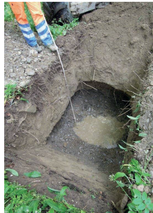
Aufgeschlossener Grundwasserspiegel in einer Sondierung im Schilfwald. Das Grundwasser zirkuliert im durchlässigen Reusschotter unter einer relativ geringmächtigen Deckschicht.
